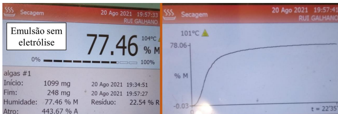
Figura B1- Resultados do teor de humidade da emulsão antes da eletrólise.
